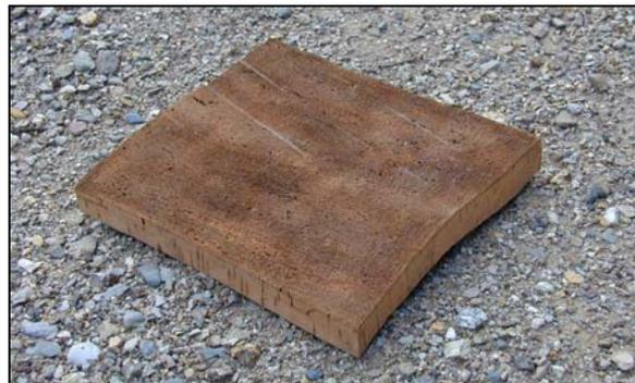
Calas de liège avant et après raclage de la partie carbonisée
